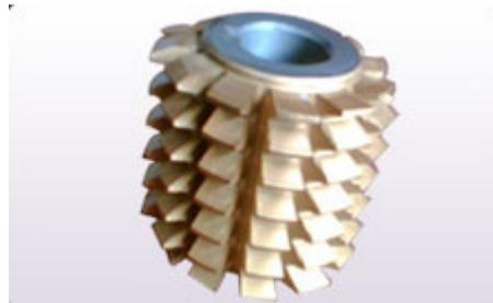
As fresas caracol para engrenagens de corrente são fabricadas para passos de ¼" a 3" ou 5 mm a 76 mm, nas normas DIN, BS, JIS e ASA. São também fabricadas com uma ou mais entradas com perfil retificado.
