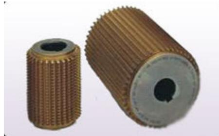
As fresas caracol para perfis estriados "STUB" com evolvente são utilizadas para corte de estrias paralelas e são fabricadas com uma ou mais entradas com ângulos de pressão "20°, 30°, 37.5° e 45° e perfil retificado.
