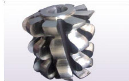
As fresas caracol para Coroa x Sem-fim são geralmente fabricadas para aplicação no processo de mergulho. São fornecidas também para o processo de corte tangencial com uma ou múltiplas entradas. As características da ferramenta, como haste e comprimento estão de acordo com as características construtivas da máquina.
